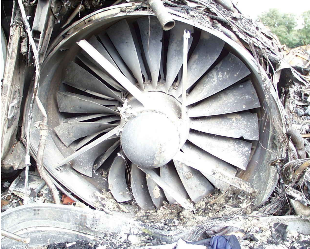
Figure 37 : Compresseur BP du moteur 1
