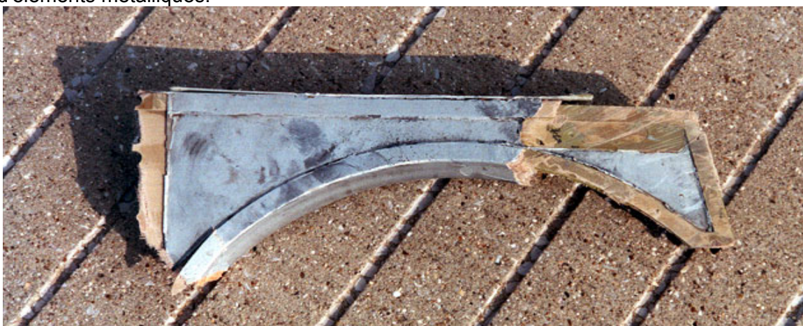
Figure 19 : Pièce située sur la ligne 157 : partie droite du déflecteur
